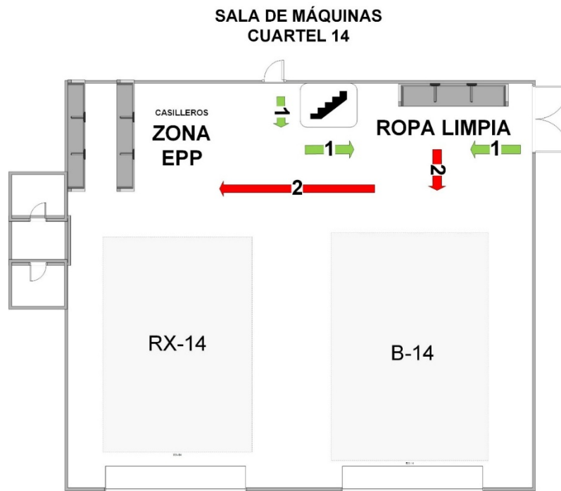
Figura 2: Circuito a seguir para vestir EPP en caso de acto de servicio. Los voluntarios que provengan de la guardia o bien desde la puerta de acceso contigua a la entrada al cuartel deberán dirigirse primero a la Zona de Transferencia para dejar ropa limpia siguiendo el flujo 1 (en verde) para proseguir a vestir EPP siguiendo el flujo 2 (en rojo)
